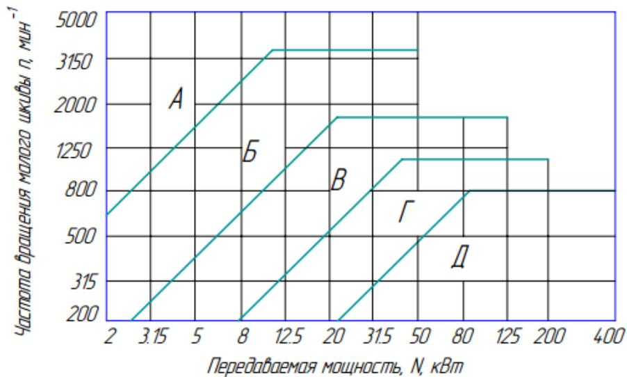
Рисунок 2 - Номограмма определения требуемого сечения ремня
