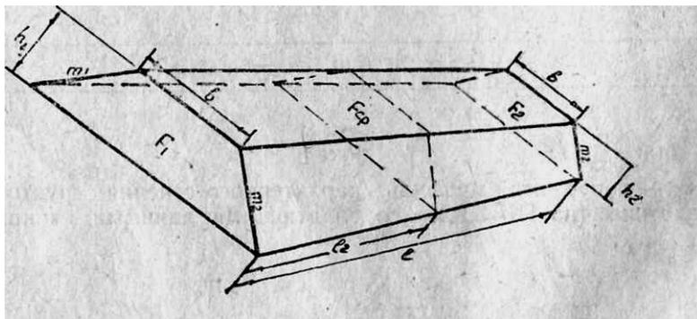
Рис.2 Расчетная схема для подсчета объемов грунтовой плотины
