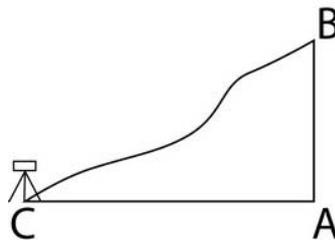
25. В формуле тригонометрического нивелирования  $h = s * \text{tg } v + i - V$  установите соответствие
