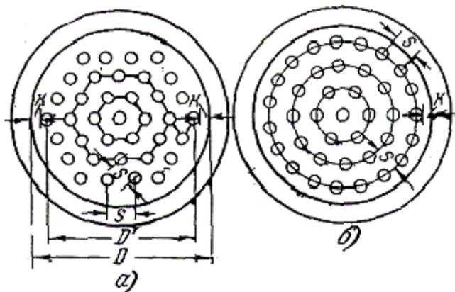
Рис. 1. Схемы размещения труб в решетках: а - по вершинам равносторонних треугольников; б - по концентрическим окружностям.
