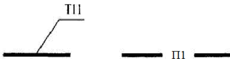
Рисунок 15 Буквенно-цифровое обозначение трубопроводов или воздухопроводов
