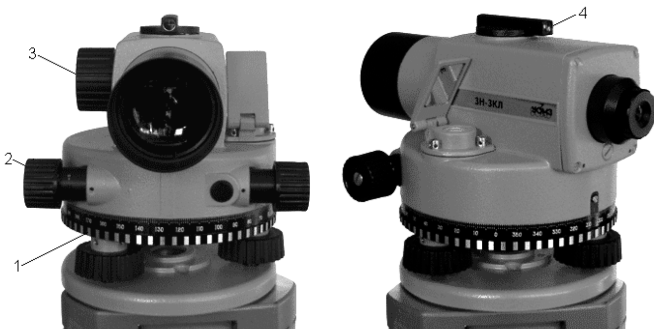
Рисунок 3. Точный нивелир 3Н-3КЛ с компенсатором и лимбом: 1 – лимб; 2 – наводящий винт; 3 – кремальера; 4 – визир
