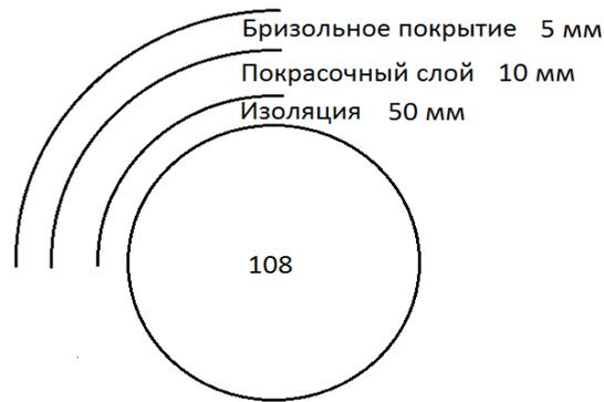
Рисунок 7 - Слои изоляции
