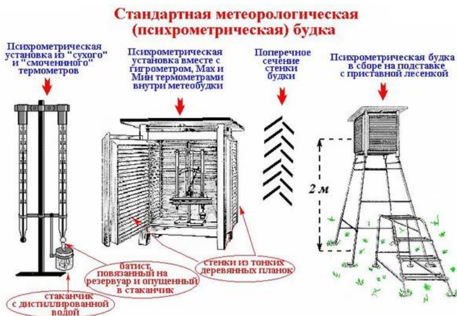
Рис. 37. Психрометрическая будка БП-1
