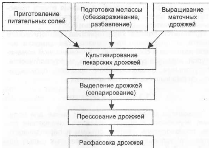
Рисунок – Технология получения прессованных пекарских дрожжей (пример)
