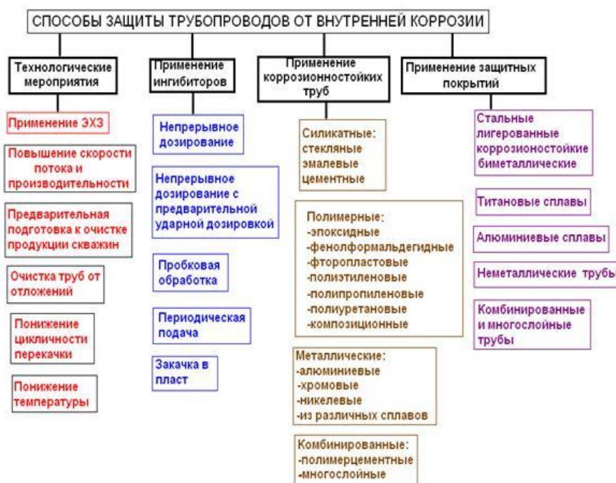
Рисунок 1 - Методы защиты трубопроводов от коррозии
