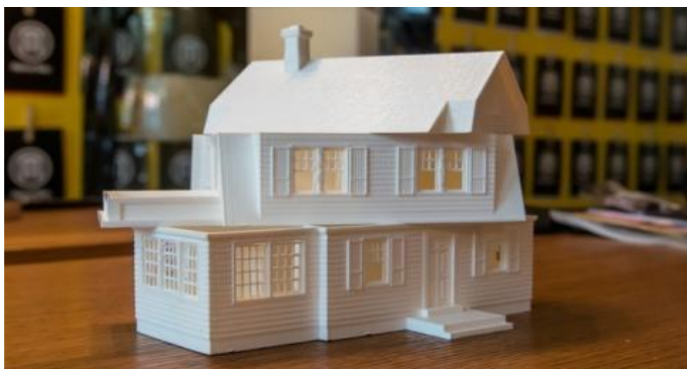
Рисунок 2 – Модель жилого дома, распечатанного на 3D принтере [2]
