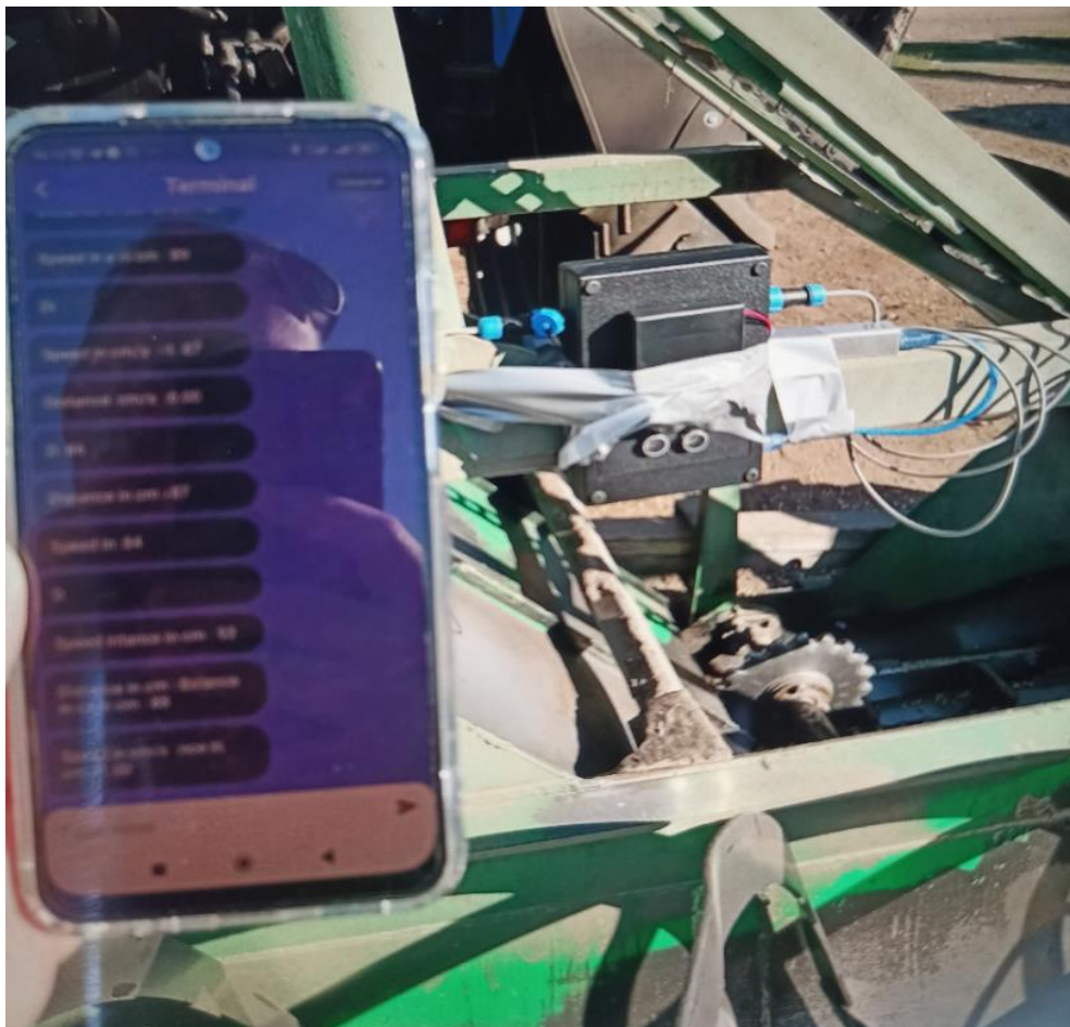
Рисунок 2. Данные о расстоянии до бурта, его высоты и скорости приближения к массиву груза на внешнем демонстрационном устройстве (экране смартфона)
