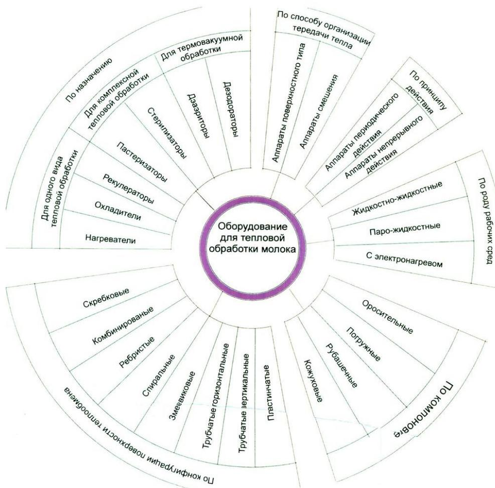
Рис. 5.1. Классификация оборудования для тепловой обработки молока
