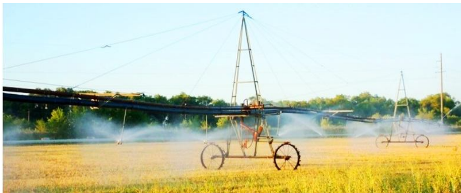
Рисунок 7 - Усовершенствованная конструкция ДМ «Фрегат»
