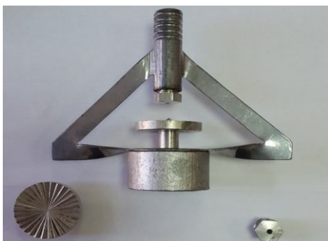
Рисунок 8 – Дождеобразующее устройство дефлекторного типа
