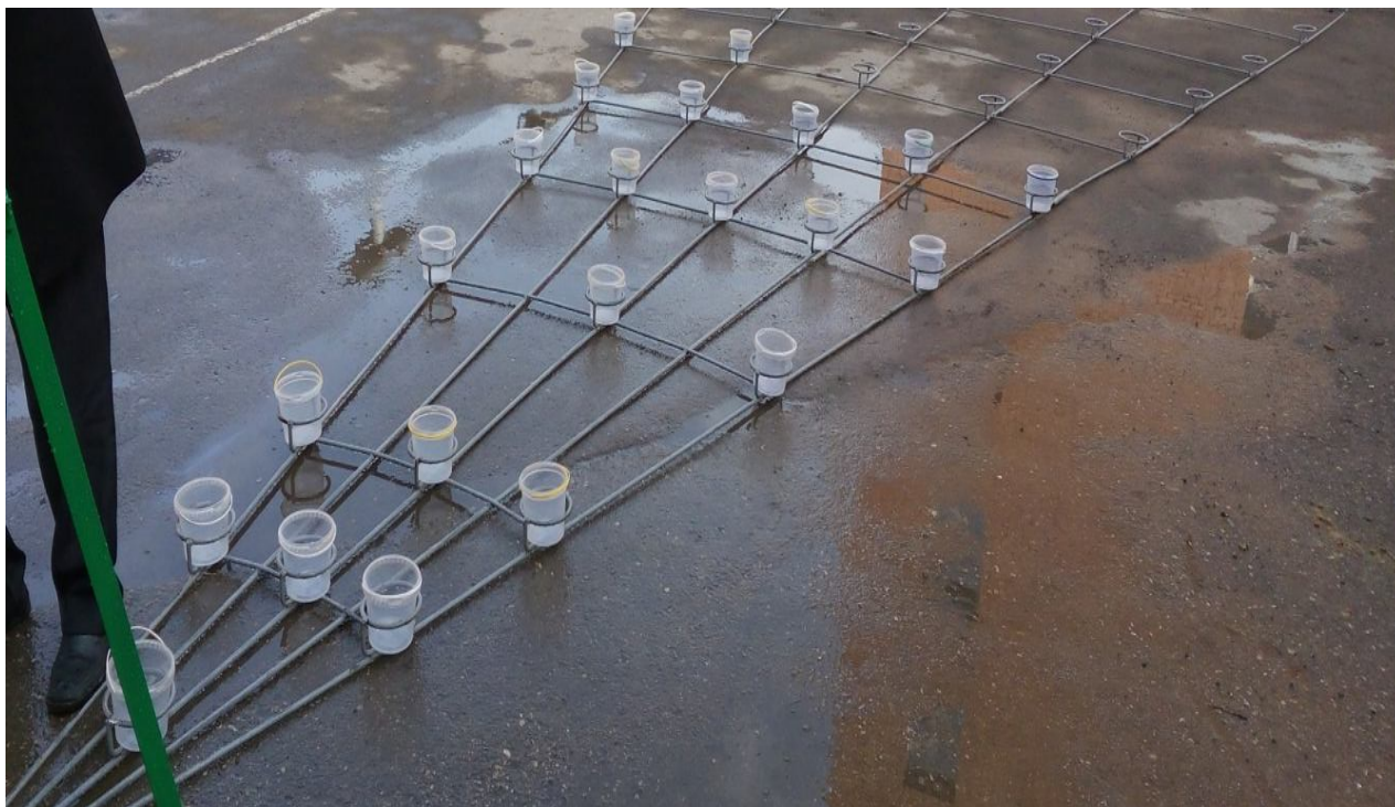
Рисунок 3.8 – Распределение дождемеров при лабораторных испытаниях дождеобразующих устройств
