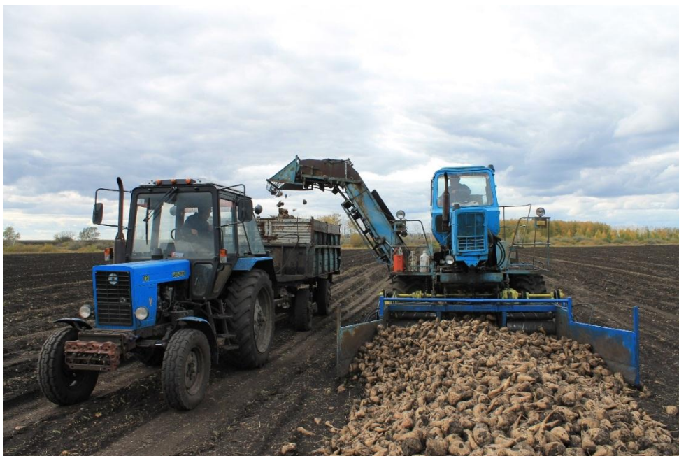
Рисунок 4.14 – Производственные испытания кулачково-планчатого питателя на погрузчике СПС-4,2
