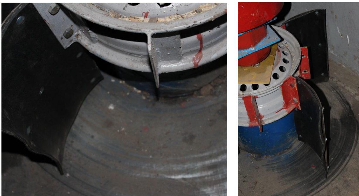
Рисунок 4.18 – Лопасты с покрытием мягкой резиной с внутренним армированием резинотканевым слоем
