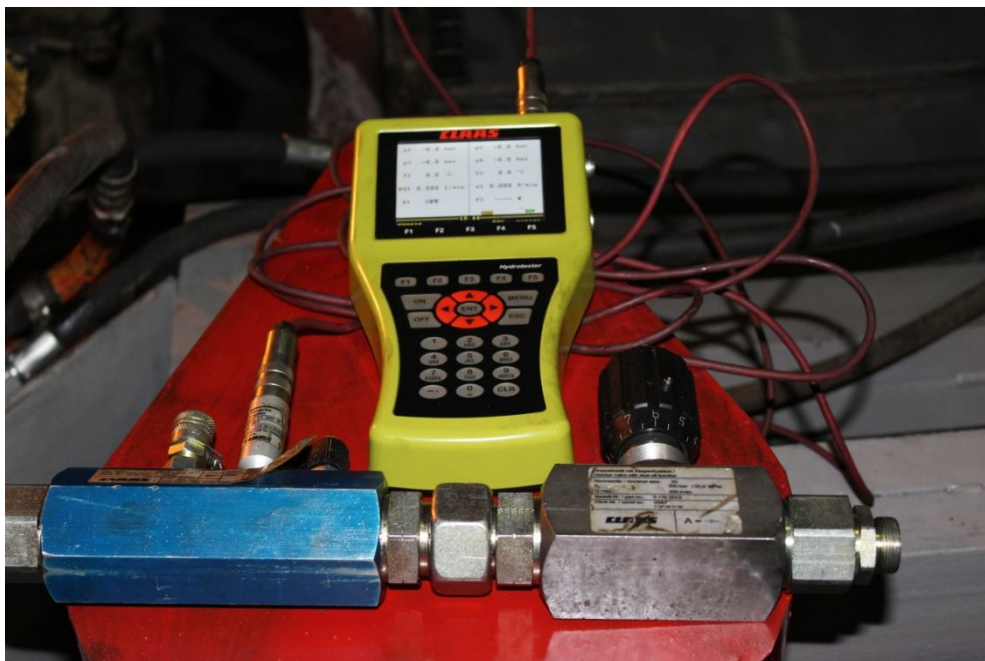
Рисунок 3.8 - Прибор «Hydrotester» фирмы CLAAS для одновременного замера расхода гидравлической жидкости и давления в гидросистеме
