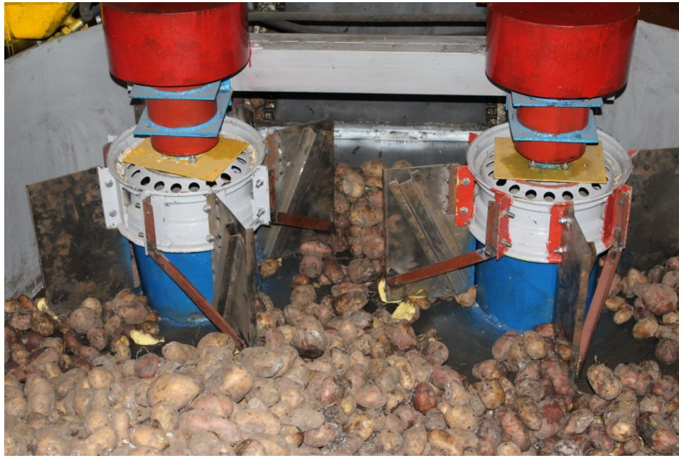
Рисунок 4.16 - Защемление клубней между плитой и нижним краем лопасти при зазоре более 40 мм
