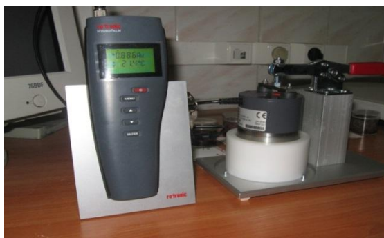
Рис. 2- Анализатор активности воды HygroPalm
