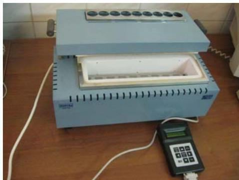
Рис. 3.4. Общий вид аппарата для определения золы
