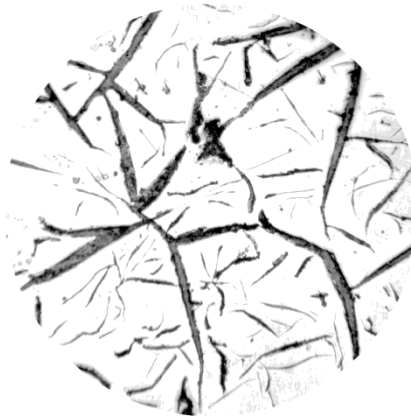
Рис.1 Микроструктура серого чугуна.
