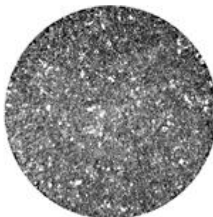
Рис. 6. Кованая и отожженная Быстрорежущая сталь P18
