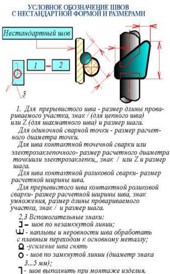
Рисунок 10.3. Условное обозначение швов
