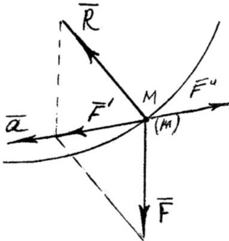
Рассмотрим движущуюся несвободную материальную точку, на которую действуют активная сила  $F$  и реакция связи  $R$ . Определим равнодействующую этих сил:
