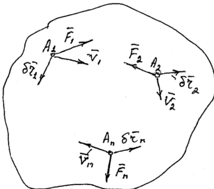
Рассмотрим механическую систему, состоящую из  $n$ - материальных точек, на которой действуют силы  $F_1, F_2, \dots, F_n$ .
