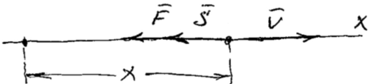
при  $p > k$  вынужденные колебания и возмущающая сила лежат в противоположных фазах.
