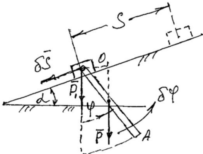
Данная система имеет две степени свободы и, соответственно, две обобщенные координаты, независимые друг от друга  $S$  и  $\varphi$ .
