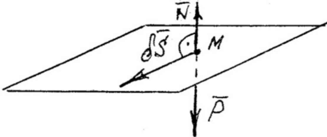
М- материальная точка, находящаяся на гладкой поверхности, Р- сила тяжести, N- нормальная реакция,  $\delta S$  - возможное перемещение. В этом случае  $\sum \delta A_{R_i} = N \cdot \delta S \cdot \cos(N; \delta S) = N \cdot \delta S \cdot \cos 90^\circ = 0$ .
