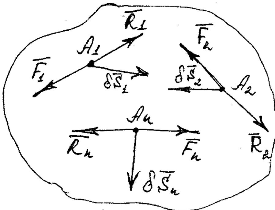
Пусть механическая система с «идеальными связями» находится в состоянии покоя, тогда для каждой точки системы:
