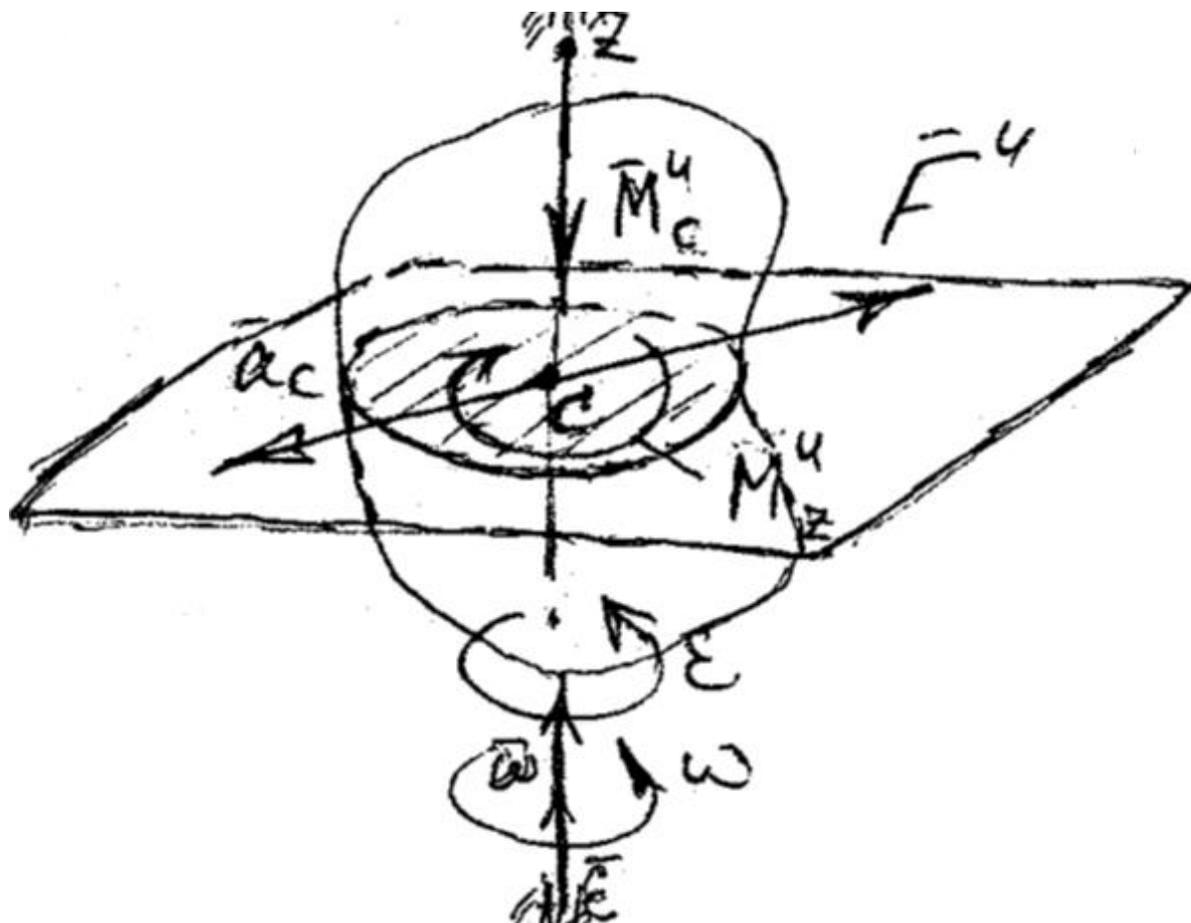
Пусть тело имеет плоскость материальной симметрии и движется параллельно ей.
