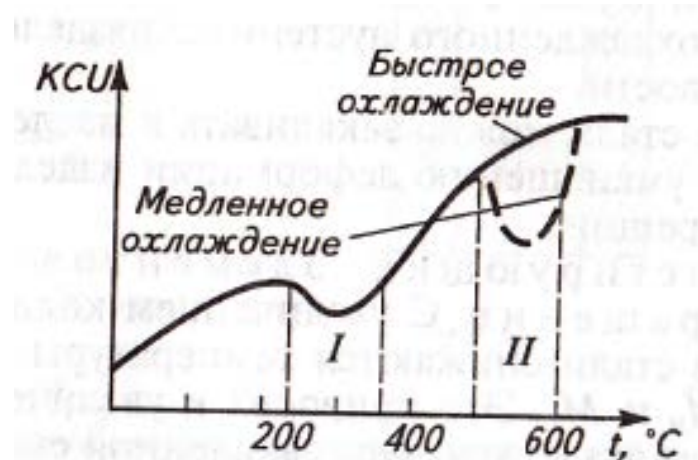
Рис. 6. Влияние температуры отпуска на ударную вязкость легированной стали
