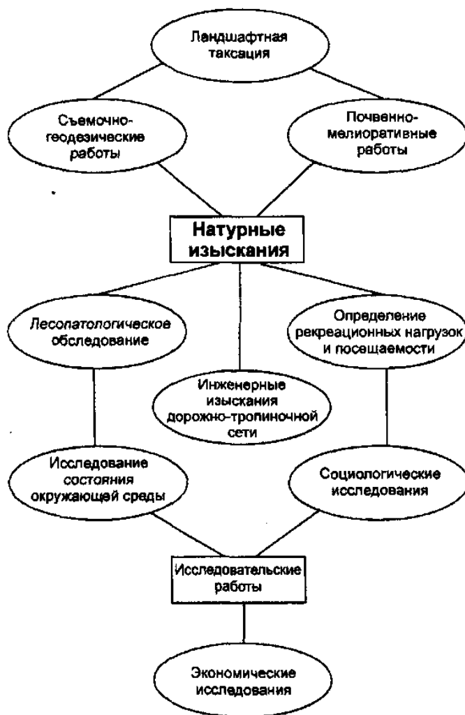
Рис. 3.1. Схема организации и состав предпроектных работ [1]
