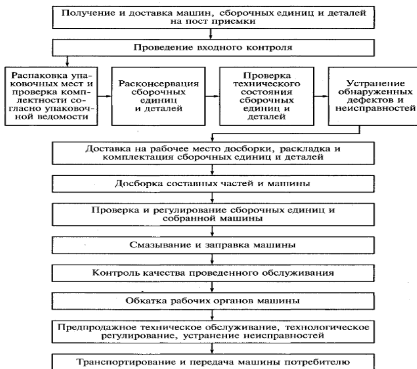
Рисунок 2.2. Схема технологического процесса предпродажного обслуживания машин.
