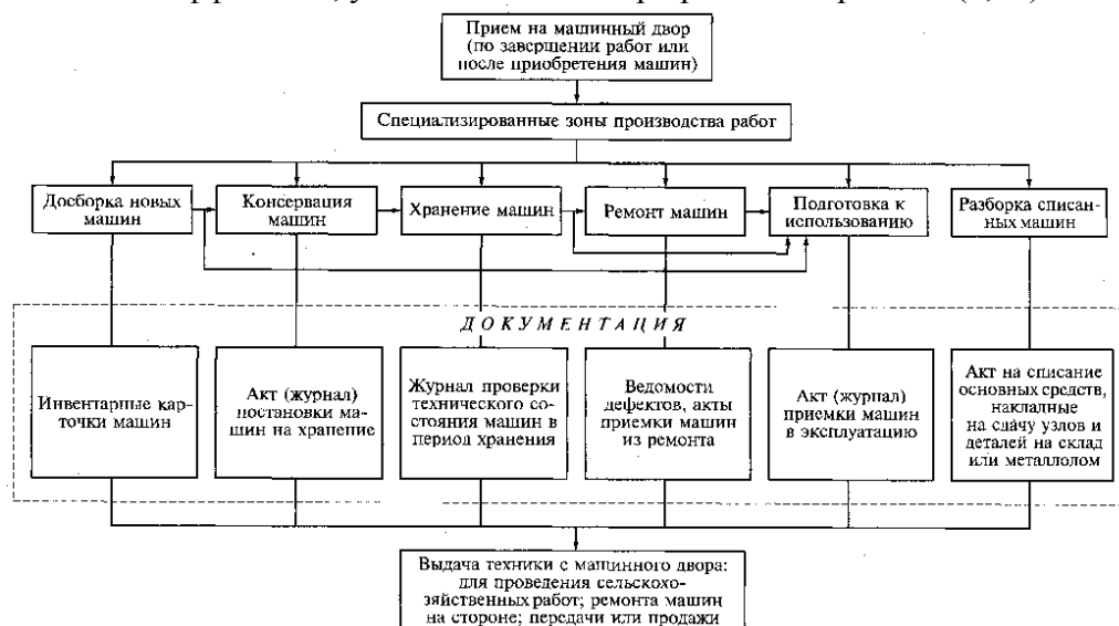
Рисунок 16.3. Технологическая схема проведения работ на машинном дворе
