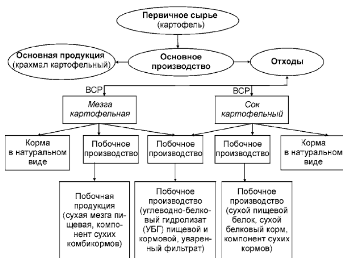
Рис. 13. Схема образования ВСР в крахмальной промышленности (Картофелекрахмальное производств)
